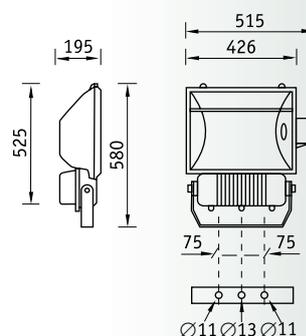
Максимальная поверхность ветровой нагрузки, м<sup>2</sup> — 0,275.
