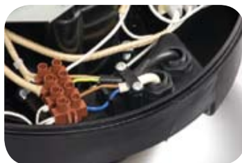
Подвод питания для рабочей и аварийной ламп.
