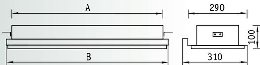
Светильник устанавливается на несущие шины реечного потолка с помощью кронштейнов, входящих в комплект.
